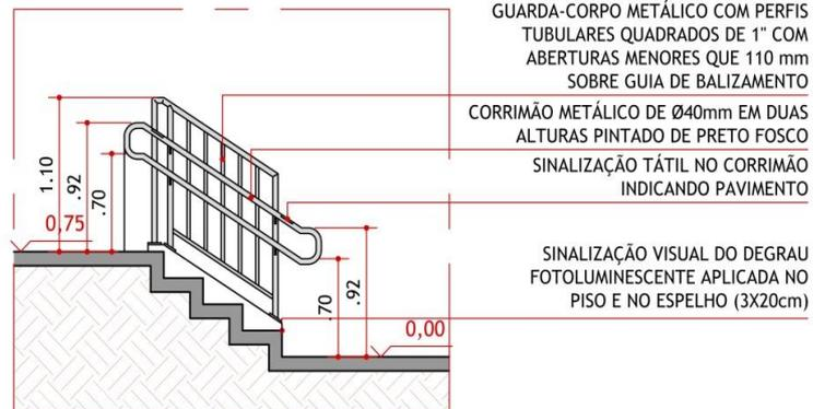
CORTE A - ESCADA SEM PAREDES LATERAIS
