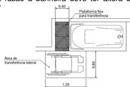
Figura 127 – Área de transferência para banheira – Plataforma fixa
