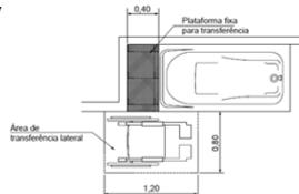
Figura 127 – Área de transferência para banheira – Plataforma fixa
